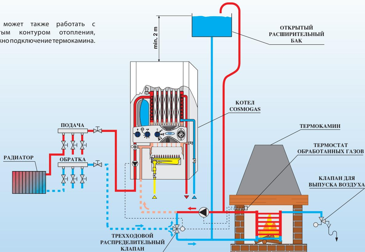
ОДИН ИЗ ПРИМЕРОВ ПОДКЛЮЧЕНИЯ КОТЛА
