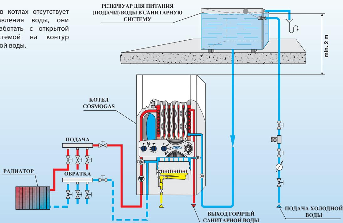
ОДИН ИЗ ПРИМЕРОВ ПОДКЛЮЧЕНИЯ КОТЛА
